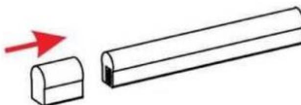
3. Вставьте штыревой коннектор со стороны подачи питания острой стороной в проводники. Нанесите на торец изделия и внутрь коннектора достаточное количество герметика и наденьте коннектор кабеля питания на неон. Следите за тем, чтобы штыри попали в гнезда коннектора. Подождите до полной полимеризации герметика.
